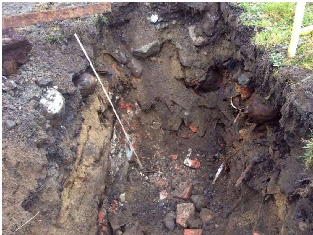
Figur 19. Sågverksområdet, typisk provtagningsgrop med stenar, grusig sand, tegel och metallskrot.
