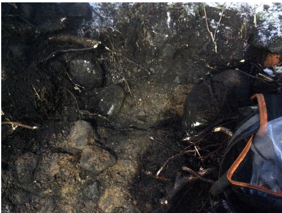
Figur 21. Galvaniseringsområdet, typisk provtagningsgrop med ytligt mullskikt följt av stenig grusig sand med inslag av stora stenar och ibland direkt på berg.
