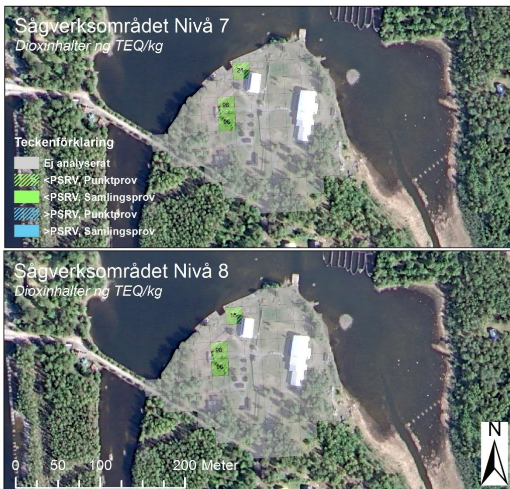
Figur 13. Dioxinutbredning med SEV på Sågverksområdet med klassificering enligt PSRV. Varje SEV (Ruta) i kartorna redovisas i grönt om samlingsprovet visar <PSRV och i blått om samlingsprovet visar >PSRV. Samtliga resultat i WHO ng TEQ/kg Upper bound. N1(Nivå 1) = 0-0,5 m, N2= 0,5-1m, N3= 1-1,5 m.
