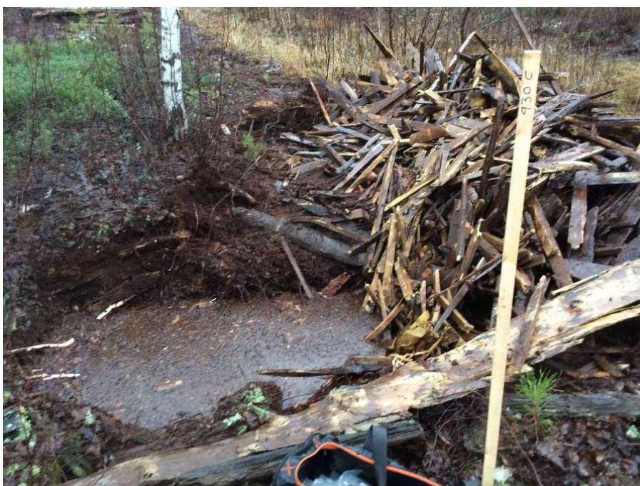
Figur 20. Långgrundets brädgård, typisk provtagningsgrop med ytligt mulskikt följt av bark, rustbädd och trärester.
