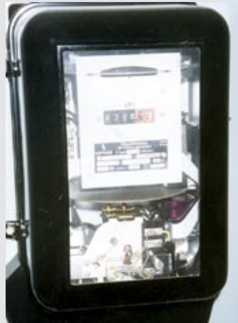
Elmätare. Fabrikat Siemens.
