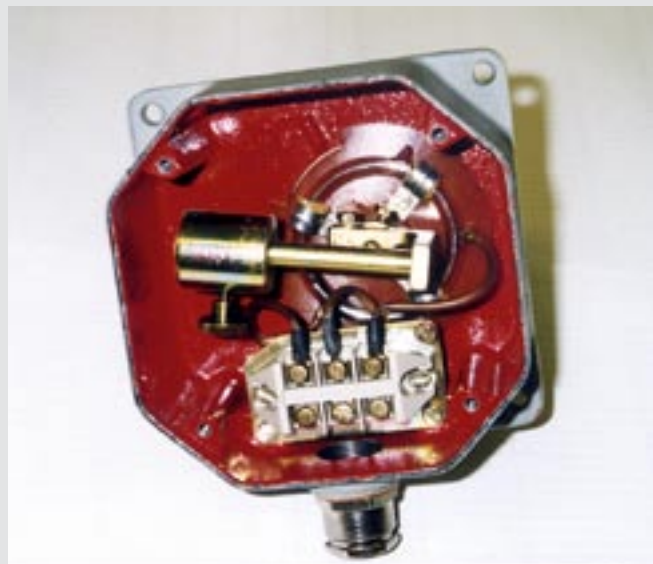
... innehållande kontaktring med kvicksilver. Fabrikat Siemens.
