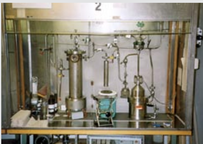
Gasanalysinstrument innehållande litervis med kvicksilver.
