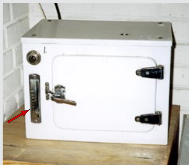
Labugn med termostat och termometer.
