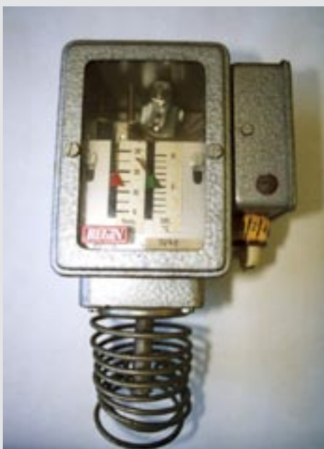
Kapillärrör med detta utseende innehåller inte kvicksilver . Obs! Det finns dock en vippa med kvicksilver i visarhuvudet. Fabrikat REGIN (Fema).
