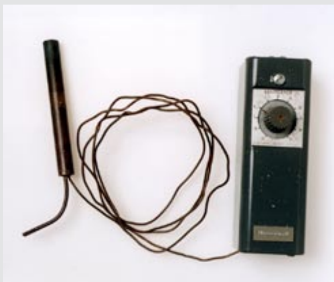
Termostat med "mjukt" kapillärrör i koppar. Denna modell innehåller inte kvicksilver .
