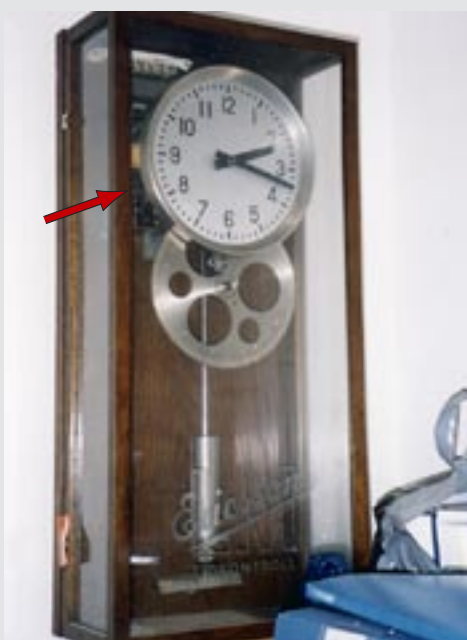
Huvudur med kvicksilvrippor bakom urtavlan. Fabrikat L.M. Ericsson.
