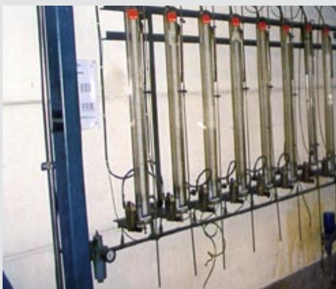
Differenstrycksmätare med pelarvisning.
