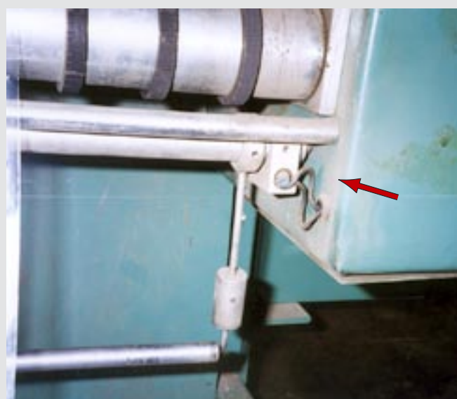
... i vilken kvicksilverbrytare fanns monterad för lägesreglering.
