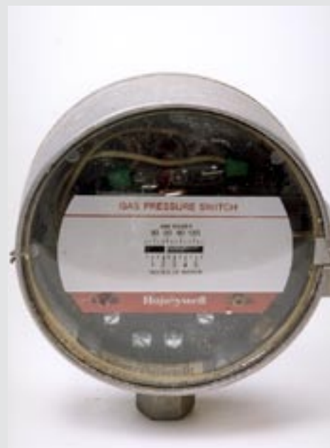
Tryckvakt. Fabrikat Honeywell.
