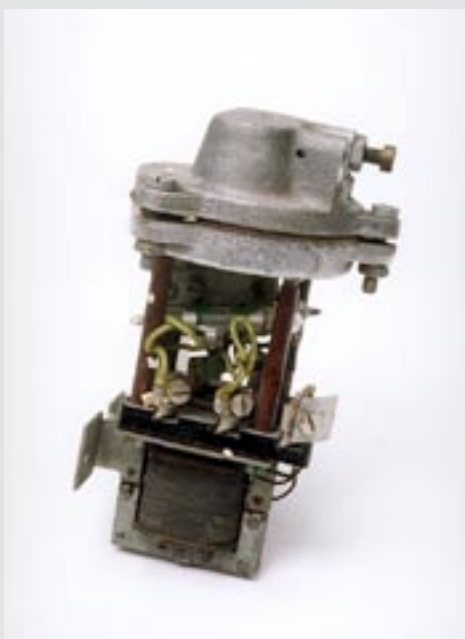
Relä med mekanisk fördröjning för hissinstallation.
