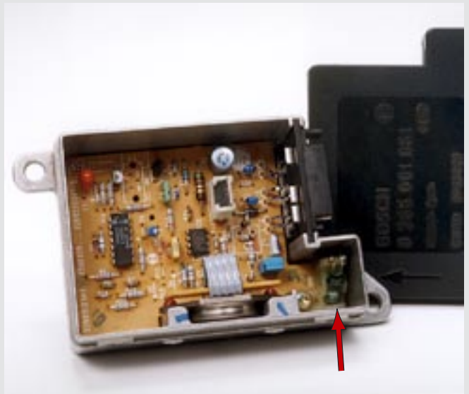
G-sensor för bältessträckare innehållande kvicksilverbrytare. Fabrikat Bosch.
