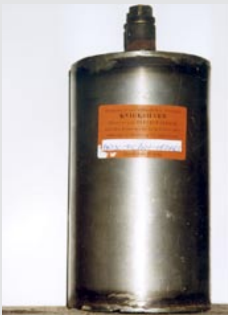
Metalliskt kvicksilver skall förvaras så att utsläpp inte sker. Här visas ett exempel på en stålflaska med välvd botten och konisk förslutning.
