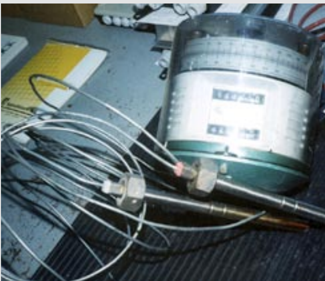
Temperaturdifferensmätare med kapillärrör.
