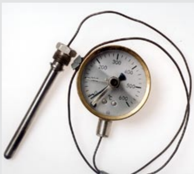
Rökgastermometer med kapillärrör som innehåller kvicksilver. Fabrikat AKM.
