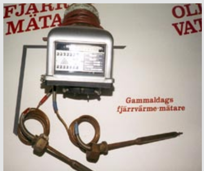
Temperaturdifferensmätare med kapillärrör.
