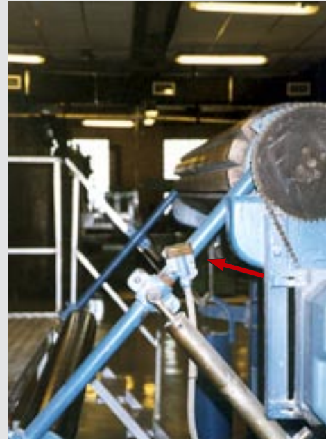
Vipa monterad på pappersmaskin för lägesreglering.
