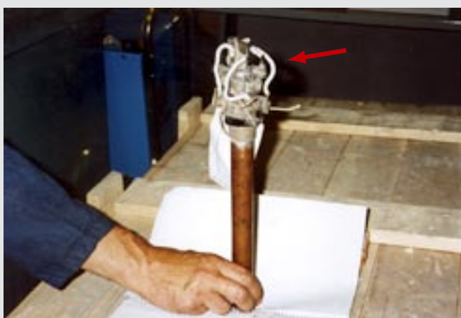
Nivåvakt med kvicksilverbrytare för inbyggnad i tank.
