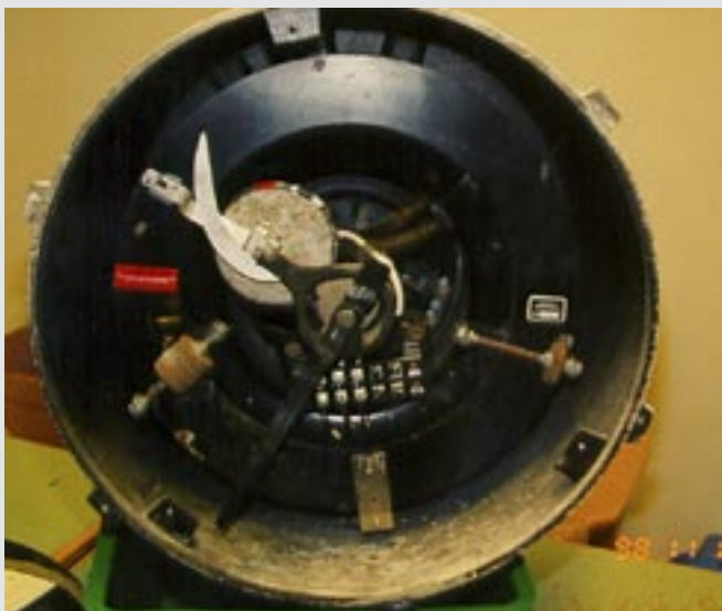
Ångmängdsmätare öppnad. Kvicksilvret finns i den sk "ringvägen". Kvicksilvret fungerar som motvikt för det flöde som är påkopplat. Motvikten får "ringvägen" i rörelse som påverkar t.ex. en visare.
