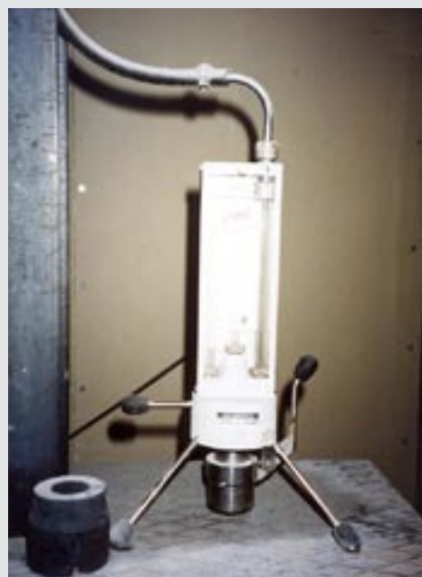
Vakuummätare med pelarvis- ning. Fabrikat Genevac.
