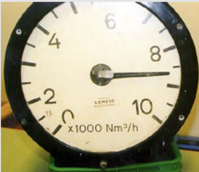
Ångmängdsmätare framsida. Fabrikat Siemens.
