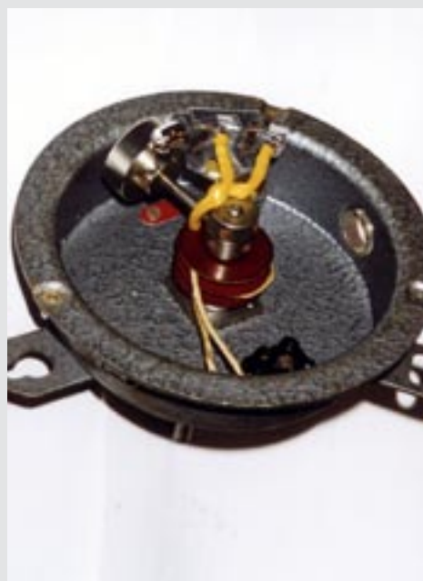
... innehållande kvicksilverbrytare. Fabrikat Siemens.
