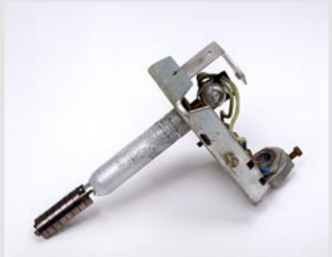
Samma termostat med demonterat dykrör. I detta fall fanns en bi-metall, men det kunde ha varit ett kapillärrör innehållande kvicksilver.
