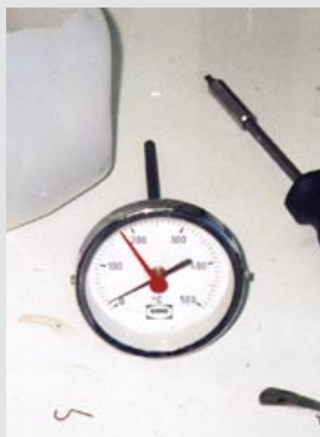
Termometer, av denna typ, med "tunt" dykrör innehåller inte kvicksilver.
