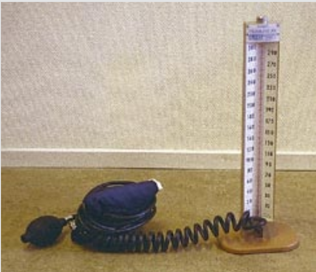
Blodtrycksmätare med pelarvisning. Fabrikat LIC.
