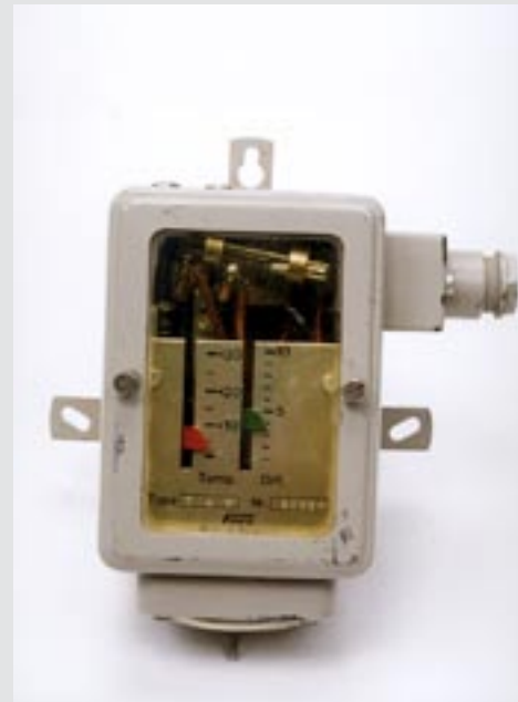
Kapslad rumstermostat med avklippt kapillärör. Fabrikat Fema (Regin).
