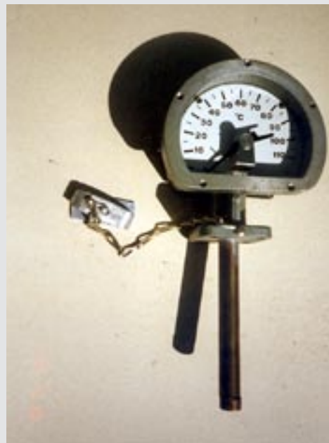
Termometer med dykrör innehållande kvicksilver. Fabrikat AKM.
