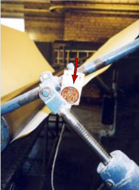
Ingjuten vipa monterad på pappersmaskin för lägesreglering.
