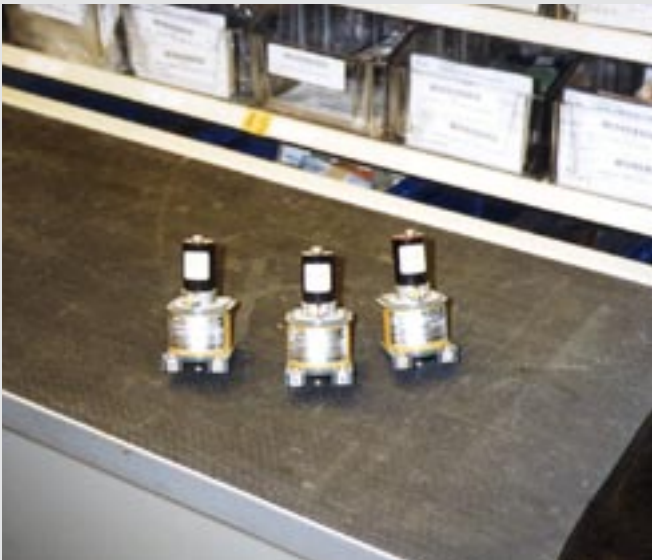
Kviksilverkontaktorer. Fabrikat ECO.
