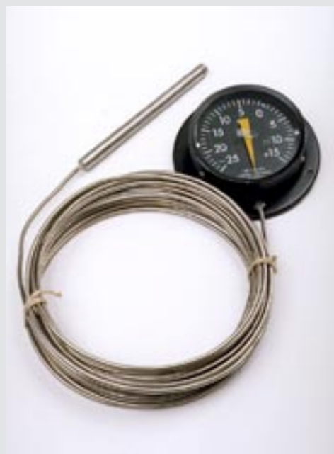
Termometer för kylrum med kapillärrör som innehåller kvicksilver. Fabrikat Svenska Industri-instrument.
