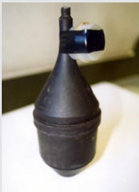
Nivåvipa. Fabrikat Inreco.
