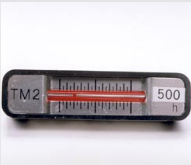
Timer med pelarvisning för utrustning som används vid tithållsoperationer. Fabrikat Fuji.
