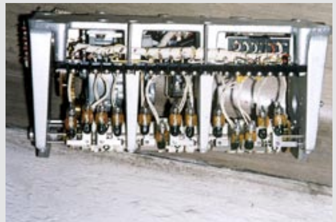
Ett demonterat räkneverk med kvicksilverbrytare.
