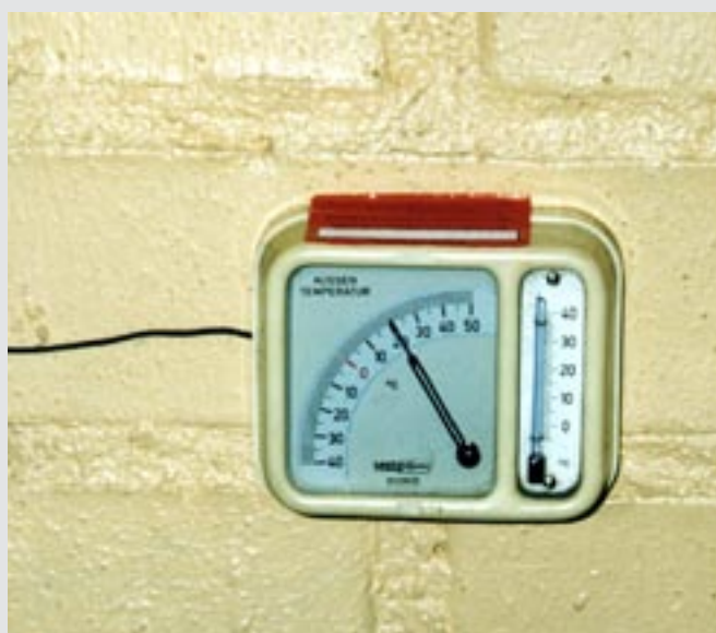
Kvikksilver finns i kapillärröret för utomhustemperaturen samt i glastermometern för inomhustemperaturen. Fabrikat Mototherm.
