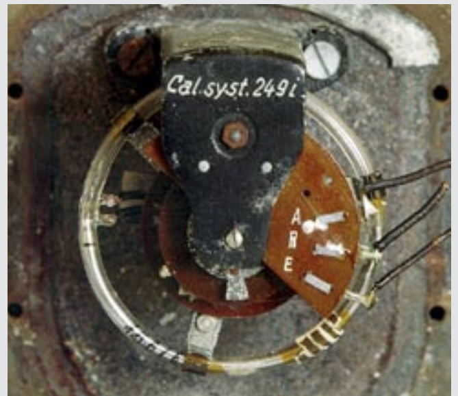
Kontaktring. När ringen vrids kommer stiften i kontakt med kvicksilvret.
