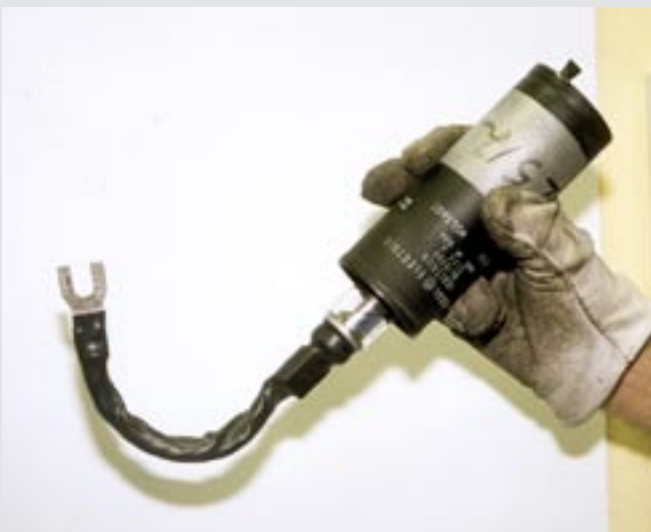
Likriktare. Fabrikat General Electric.
