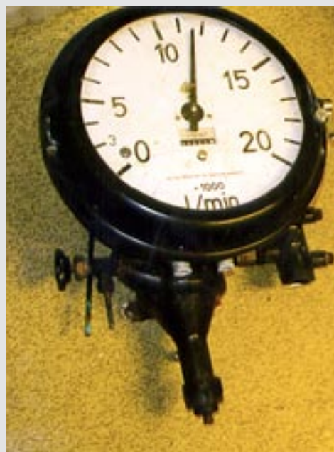
Flödesmätare. Fabrikat Zander & Ingström
