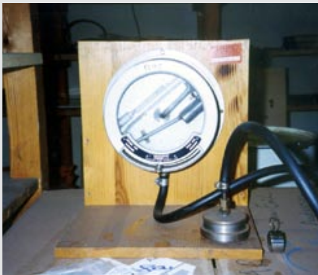
Vakuummätare med pelarvisning.
