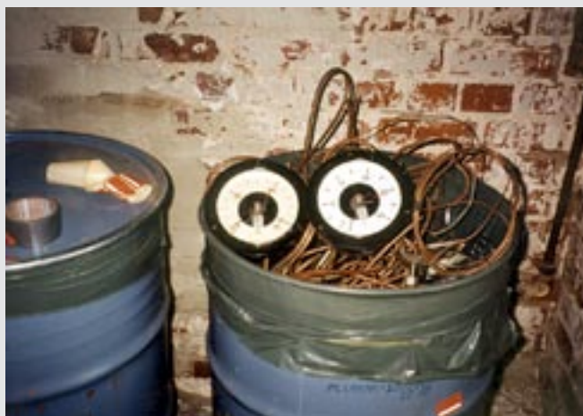
"Mjuka" kapillärrör i koppar innehållande kvicksilver. I detta fall termometrar.
