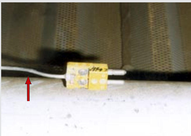
Stickanslutning med kapillärör. Då kvicksilvret i kapillärörret expanderar sluts eller bryts kretsen genom stickanslutningen. På så vis fungerar den som en brytare.
