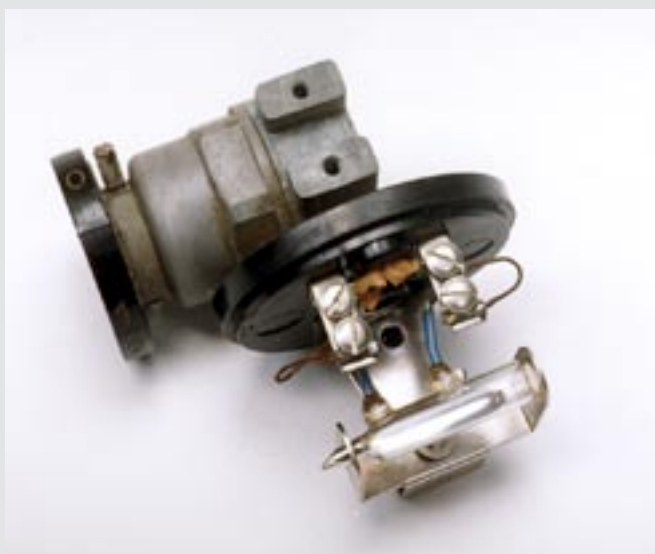
I temperaturregleringen till ammoniakkylskåp finns en kvicksilvervippa monterad.
