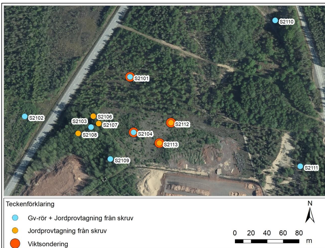
Figur 3: Undersökningspunkter för installation av grundvattenrör samt jordprovtagning.
