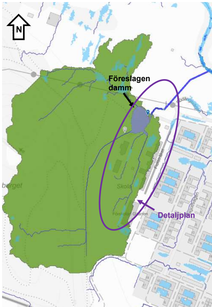
Figur 7. Avrinningsområde (grönt) för dagvattnet som rinner till föreslagna yta för damm (Scalگو Live, 2021).
